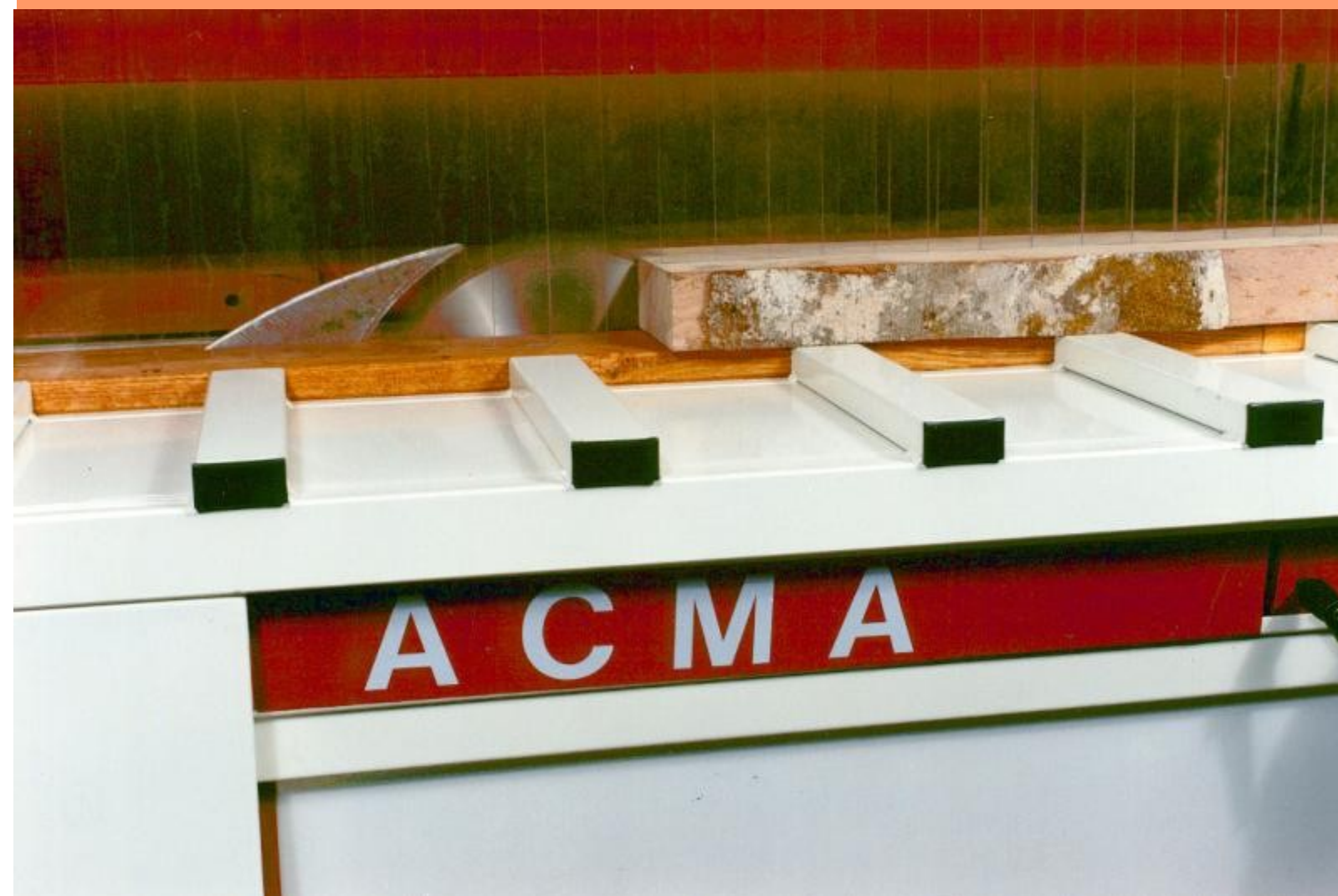
Machine équipée d'une commande DIGIT. Le pupitre peut coulisser tout le long de la machine.
