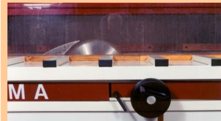
Délineuse DM82 standard capacité 3 m de coupe
