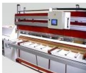
Machine équipée d'une commande DIGIT. Le pupitre peut coulisser tout le long de la machine.
