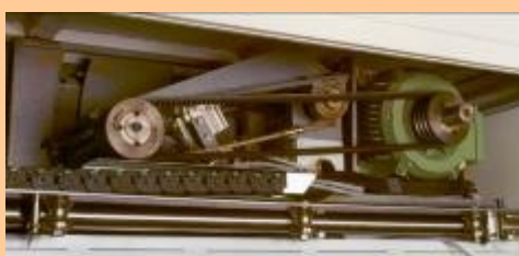
Vue de détail du chariot. Le motorisation peuvent varier de 7,5 à 15 kW selon option. La hauteur de coupe est sélectionnable au pupitre de commande.
